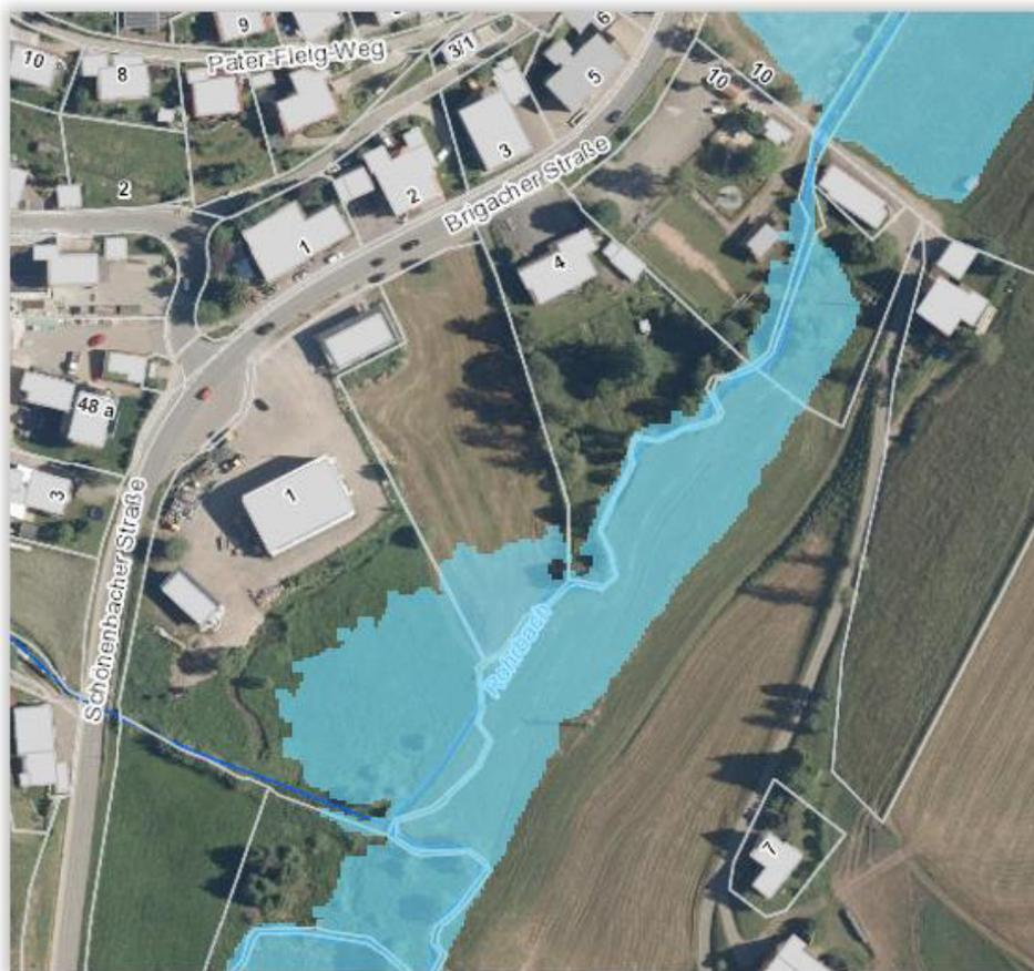
**Abbildung 7: Abgrenzungen der errechneten Flächenausdehnung eines 100-jährlichen Hochwassers**
