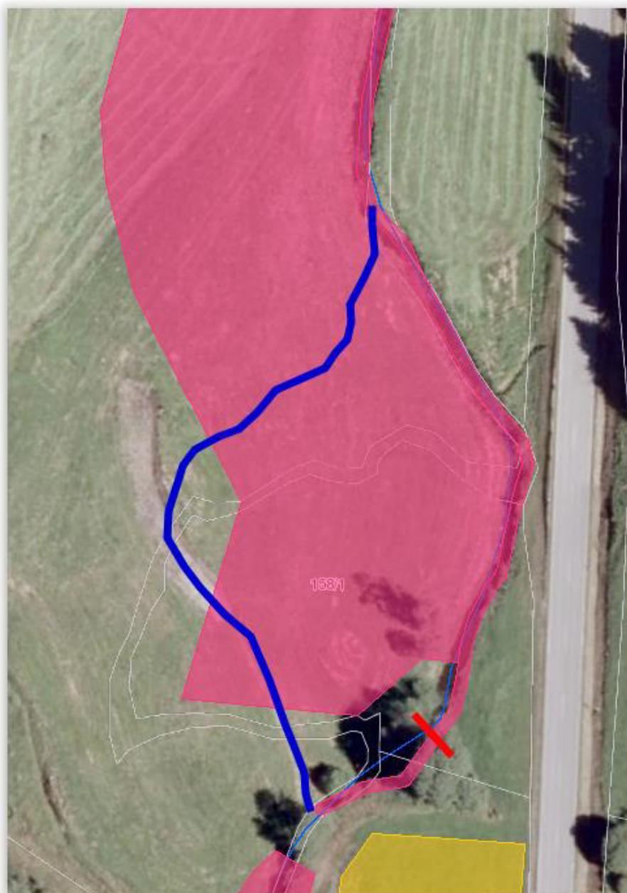
**Abbildung 1: geplante Bachrückverlegung des Rohrbachs in die Talaue, rot der bestehende Sohlabsturz (Quelle: RIPS Daten LU BW 2018)**
